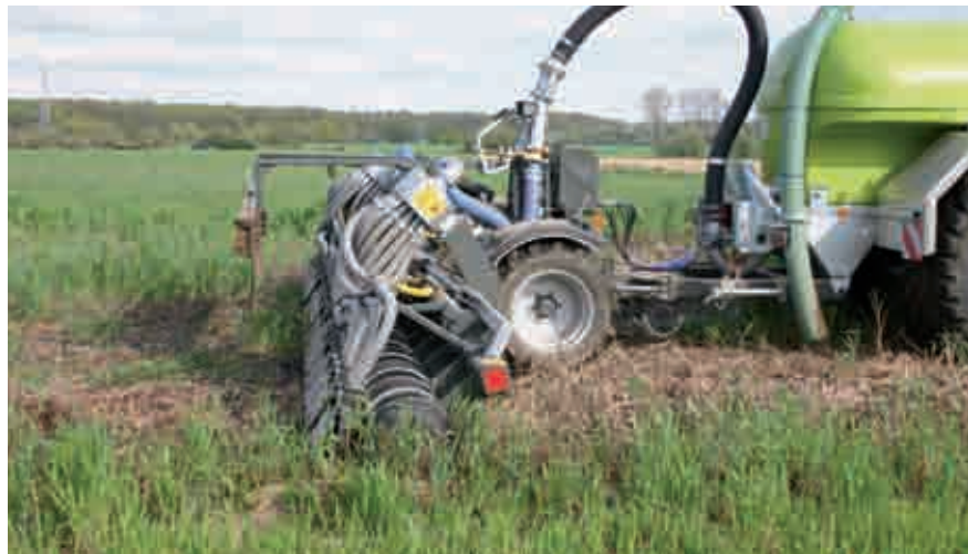
Bild 2: Schlitzgerät Gramline 8 M seitlich fotografiert bei der Gülleausbringung in einem Zwischenfruchtbestand
