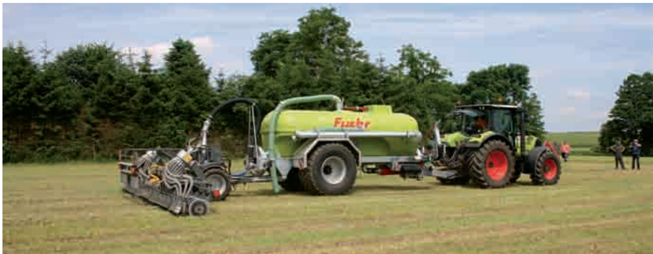
Bild 5: Schlitzgerät Gramline 8 M, angebaut an einem Pumptankwagen der Firma Fuchs
