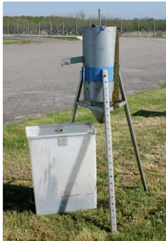
Bild 6: Fluidmeter zur Bestimmung der Fließfähigkeit von Flüssigmist
