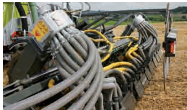
Bild 4: Zwei Harsø-Verteiler mit jeweils 16 Abgängen
