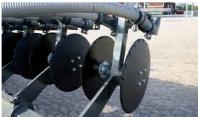
Bild 3: Scheiben mit montiertem Scheibenaufsatz zur Gülleausbringung auf bearbeitetem Ackerland
